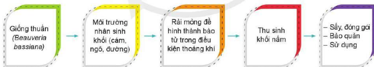
Hình 4.4. Quy trình sản xuất thuốc bảo vệ thực vật sinh học từ nấm Beauveria bassiana
