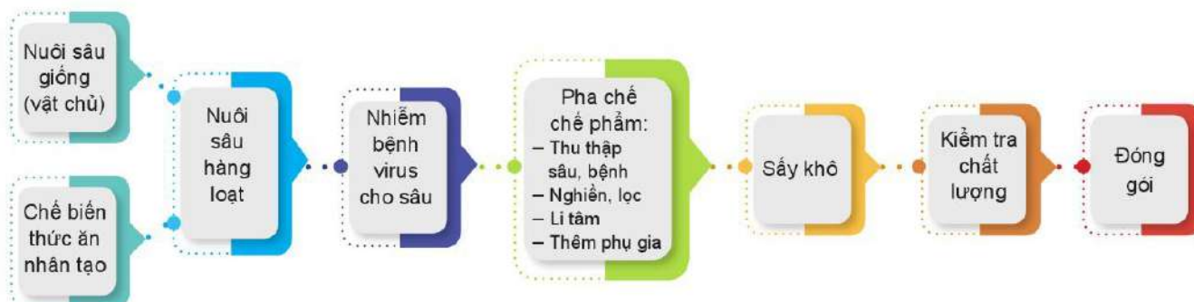
Hình 4.5. Quy trình sản xuất thuốc bảo vệ thực vật sinh học từ virus NPV
